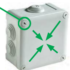
■ Vis imperdables ■ Fermeture visuellement repérable, la flèche de la vis dirigée vers le centre de la boîte.
