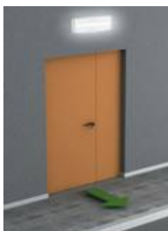
À proximité et immédiatement à l'extérieur de chaque sortie.
